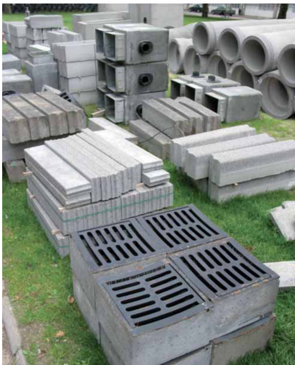
Het gangbare inrichtingsinstrumentarium voor hemelwateropvang maakt deel uit van een omvangrijk ondergronds netwerk van buizen en pijpen
