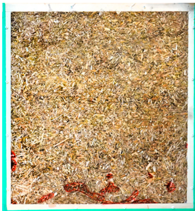
Isolatie van lisdodde. Bron: Bouwgroep Dijkstra Draisma
